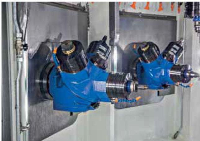
*I moduli di lavoro sono muniti di cambio utensile a revolver a tre posizioni*
