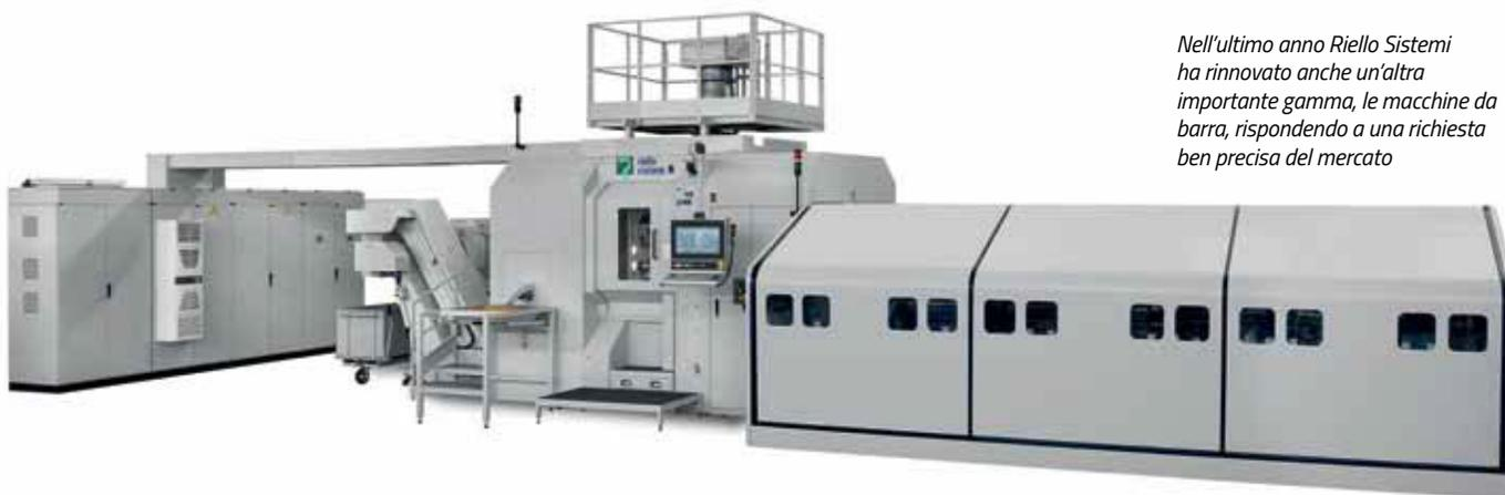
dedicate al carico e allo scarico dei pezzi da lavorare. La scelta di due stazioni di carico/scarico è stata fatta per dare la possibilità alla macchina di lavorare in scatto singolo oppure in scatto doppio: in presenza di pezzi particolarmente complessi, per esempio, può essere necessario effettuare due giri di tavola per ottenere il pezzo finito.
