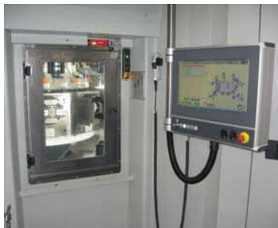
A sinistra: il transfer flessibile TFL 400 installato in P.E.L. ha un imponente corpo macchina da 92 tonnellate
